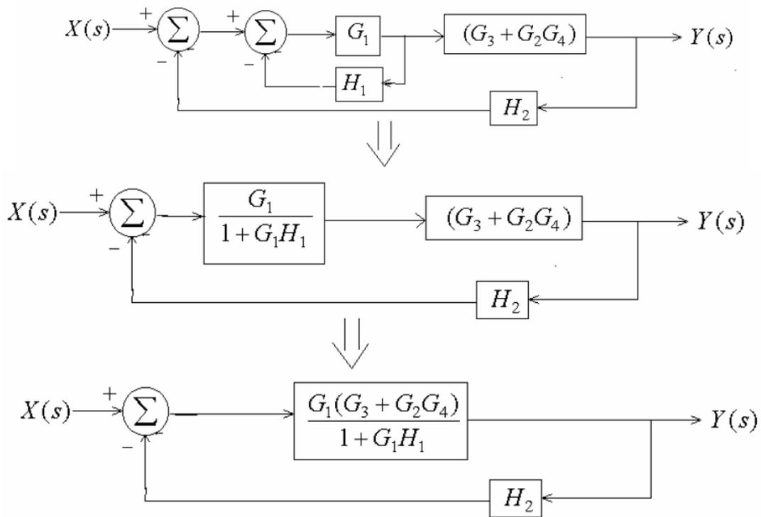
$$\frac{Y(s)}{X(s)} = \frac{\frac{G_1(G_3 + G_2G_4)}{1 + G_1H_1}}{1 + \frac{G_1(G_3 + G_2G_4)}{1 + G_1H_1}H_2} = \frac{G_1(G_3 + G_2G_4)}{1 + G_1H_1 + H_2G_1(G_3 + G_2G_4)}$$
